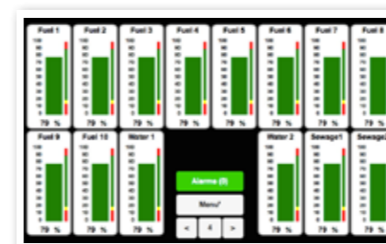
Monitoraggio livelli e sentine con indicatori a barra Monitoring levels and bilges with bar indicators
